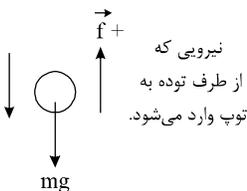
$$v^2 - v_0^2 = 2g\Delta y \rightarrow \begin{cases} v_0 = 10 \frac{m}{s} \\ \Delta y = 40 m \end{cases}$$
