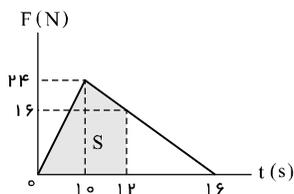
$$S = S_{\text{مثلث کوچک}} + S_{\text{نوزنقه}} = S_{\text{مثلث بزرگ}} - S_{\text{مثلث کوچک}} = \left(\frac{16 \times 24}{2}\right) - \left(\frac{16 \times 4}{2}\right) = 160$$
