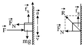
جسم روی دیواره نمی لغزد؛ پس اصطکاک از نوع ایستایی است. (دقت کنید چون در صورت سؤال اشاره ای نکرده که جسم در آستانه حرکت قرار دارد، پس نیروی اصطکاک
