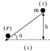
هر سه گلوله  $h$  یکسان ولی  $m$  متفاوت دارند پس انرژی جنبشی آنها با هم متفاوت است.
